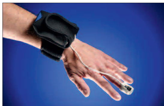
Pulsoximeter des Fraunhofer Instituts für Integrierte Schaltungen. Die Daten können per Kabel, Bluetooth oder ZigBee übertragen werden: Nach Ansicht der deutschen Ärzteschaft muss bei der Einführung telemedizinischer Anwendungen der Nutzen für den Patienten im Mittelpunkt stehen. Foto: Fraunhofer IIS
